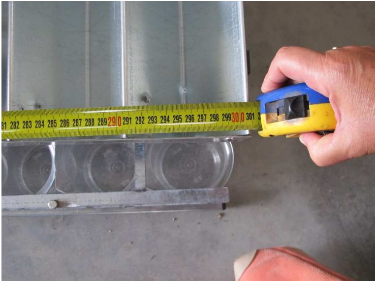
Verifica delle caratteristiche tecniche standard di un banco prova verticale. Controllo della dimensione delle singole canaline.
