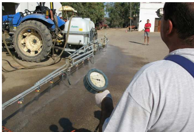
Controllo funzionale di una barra irroratrice. Fase della verifica della pressione di uscita dall'ugello di fine barra
