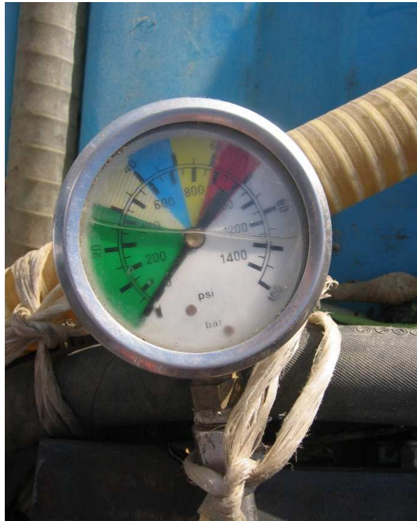
Il manometro rotto (situazione purtroppo frequente sulle irroratrici controllate) non consente nemmeno di conoscere a che pressione si distribuisce il prodotto fitosanitario
