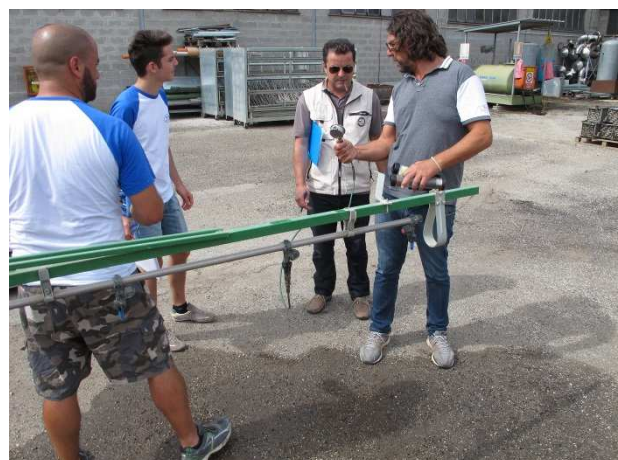
Figura 2. Verifica durante le fasi di controllo della macchina irroratrice
