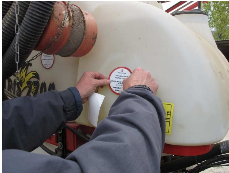
Apposizione del bollino adesivo sull'irroratrice controllata positivamente, fase conclusiva delle operazioni di verifica
